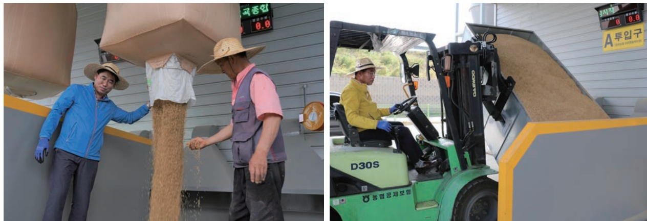
● 벼 투입을 기존 툰백 방식(왼쪽)에서 수매통 방식으로 개선함으로써 산물벼 수매 및 저장 업무의 효율이 높아졌다.
